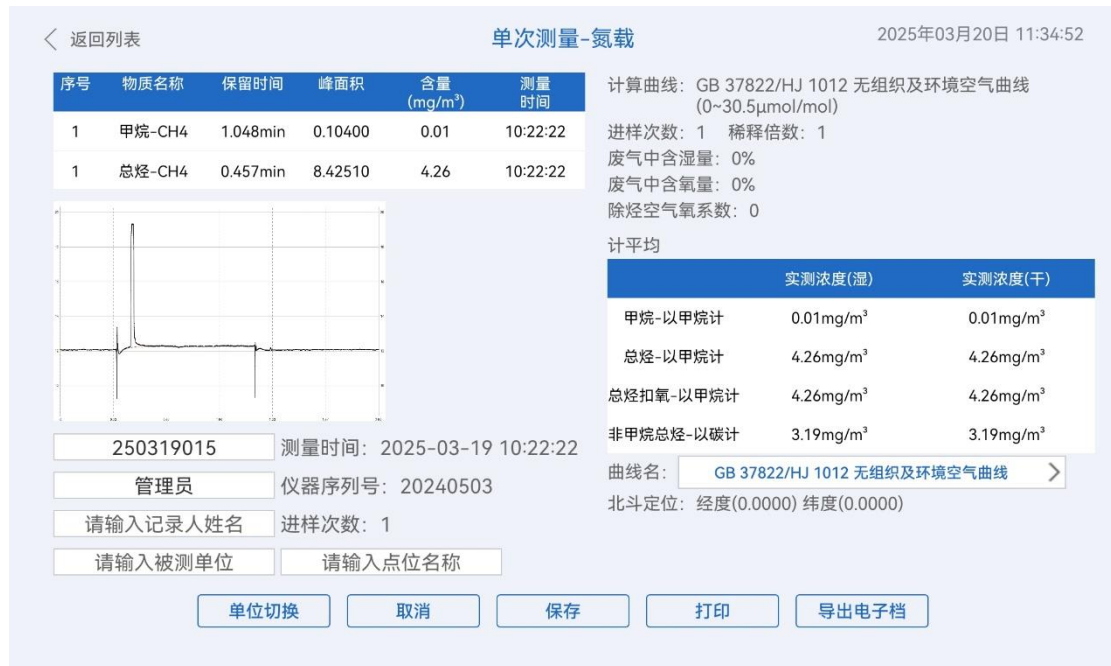
附 2: FEP 采气袋空白加热气谱图
